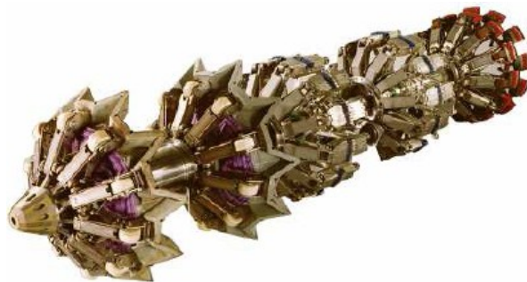
Obr. 14 Inteligentní ježek využívající Foucaultův proud [8]
