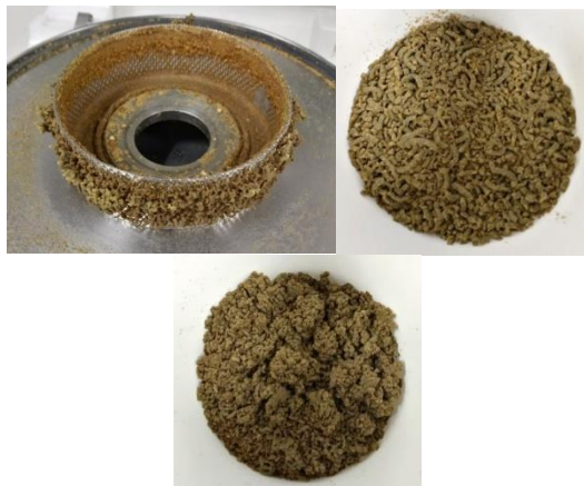
Obr. 2 Změna charakteru vzorku katránu během mletí (síto 1,5 mm a 0,5 mm)
