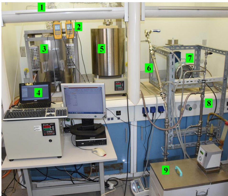
Obr. 4 Sériové propojení pyrolýzní aparatury s reaktorem pro termické zatížení (1 – vyhřívané propojovací potrubí, 2 – teploměry, 3 – pyrolýzní pec, 4 – PC pro záznam dat a regulaci, 5 – pec s reaktorem pro termické zatížení, 6 – primární chladič, 7 – bubnový plynoměr, 8 – sekundární chladič, 9 – cirkulační chladičí jednotka)
