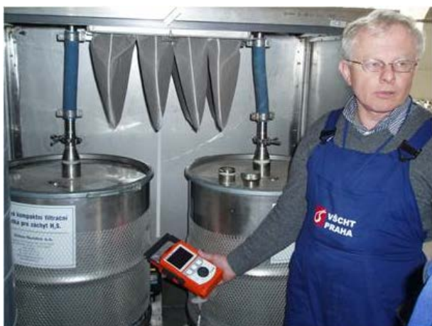
Obr. 3: Foto prvního stupně adsorpčního zařízení použitého k čištění odpadních plynů s velmi vysokými koncentracemi H_2S
