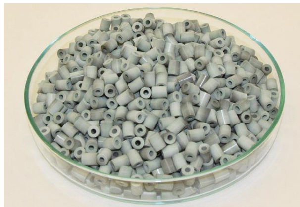
Obr. 3 Peletky katalyzátoru po první impregnaci Fig. 3 Pellets of the catalyst after the first impregnation
