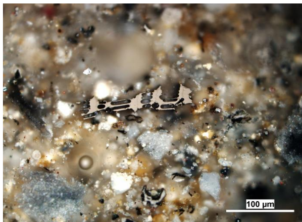
Obr. 4 Částice inertoidu a drobné fragmenty polokoksu mezi zrny pestré minerální fáze
