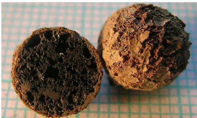
Obr. 6 Řez a povrch zrna z CJ za přídavku 3,3 % hm. VPF (podklad - milimetrový papír) Fig. 6. Cut and grain surface of CJ with addition 3.3 wt. % VPF (underlay - millimeter scale paper)
