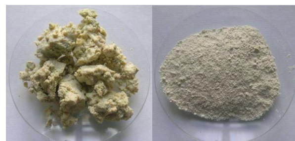
Obr. 2. Vápnofos-odkaliště surový (vlevo) a vysušený
