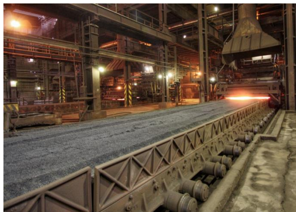
Obr. 8 Aglomerace železné rudy na spékacím pásu [35] Fig. 8 Agglomeration of iron ore on belt conveyor [35]
