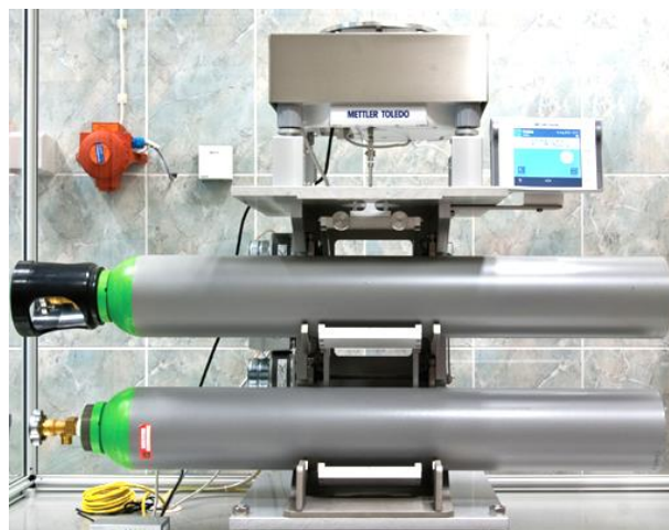
Obr. 2 Analytické váhy Kalipro 15 [6] Fig. 2 Analytical Balance Kalipro 15 [6]
