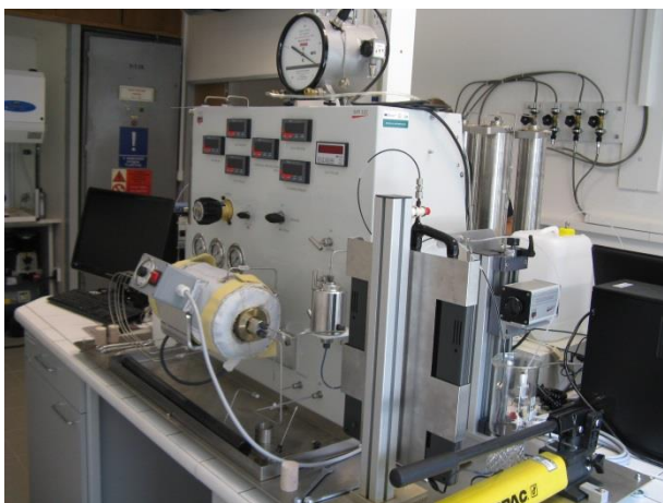
Obr. 5 Fázový permeametr BRP 350 (VINCI, Francie)
