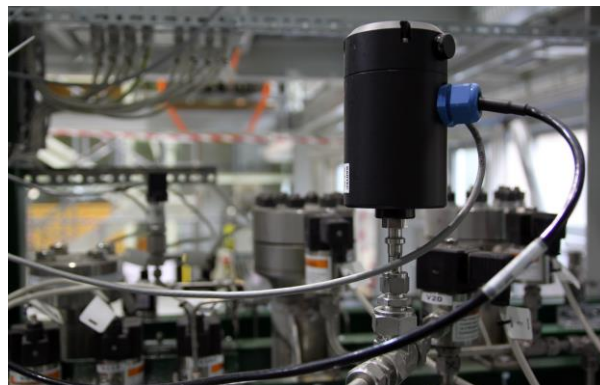
Obr. 11 Čidlo hygrometru BARTEC 5673 integrované do smyčky HTHL
