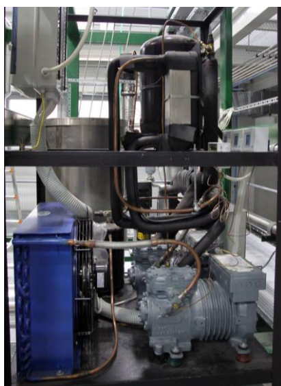
Obr. 7 Nízkoteplotní adsorbér s chladicím aparátem
