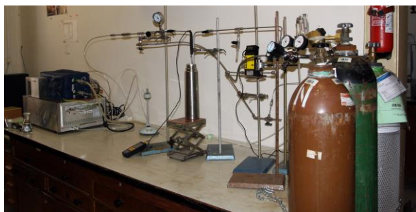
Obr. 15 Aparatura pro testování adsopčních postupů čištění helia s analyzátozem FTIR na VŠCHT Praha
