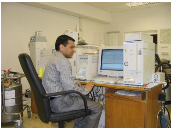
Obr 17 Trubičkový a kanystrový systém s GC-MS pro analytiku plyných vzorků
