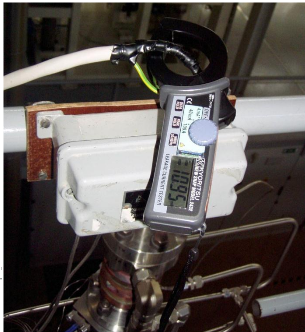
Obr. 2 Měření unikajících proudů mezi topnými spirálami a pláštěm vestavby při provozu HTHL
