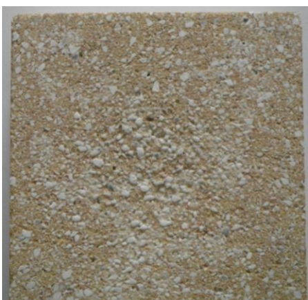
Obr. 7 Fotografie vzorku dinasu DH po zkoušce, objem odstraněného materiálu 2,8 cm 3
