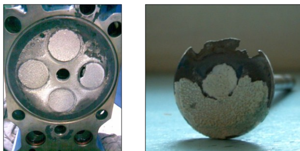
Obr. 3. Hlava válce a propálený ventil pokrytý vrstvou SiO 2 .
