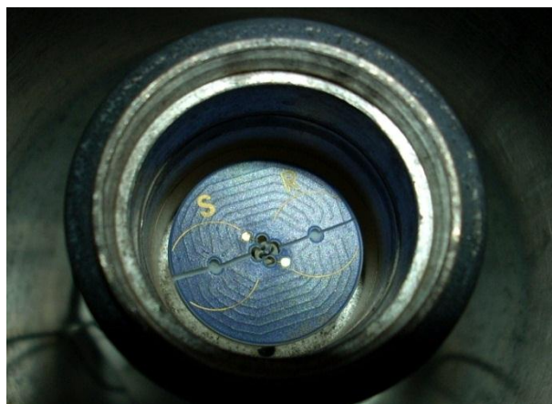
Obr. 3 Prasklý DSC senzor
