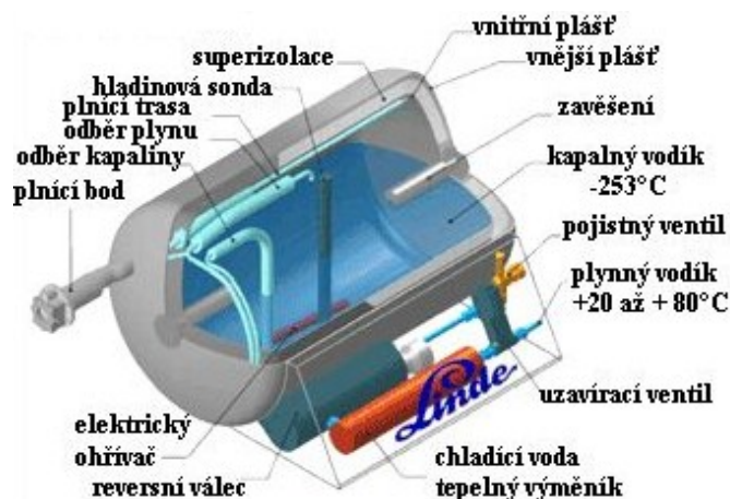
Obr. 2 Schéma nádoby na kapalný vodík [9]
