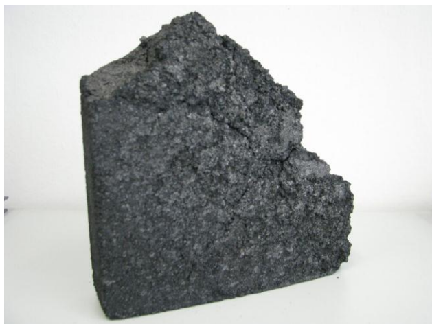
Obr. 4 Černouhelný koks vyrobený v poloprovozní koksovací jednotce
