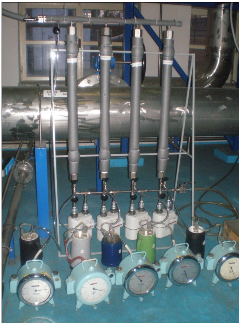
Obr. 2 Fotografie poloprovodní aparatury pro testování adsorbentů k odstraňování siloxanů z bioplynu.
