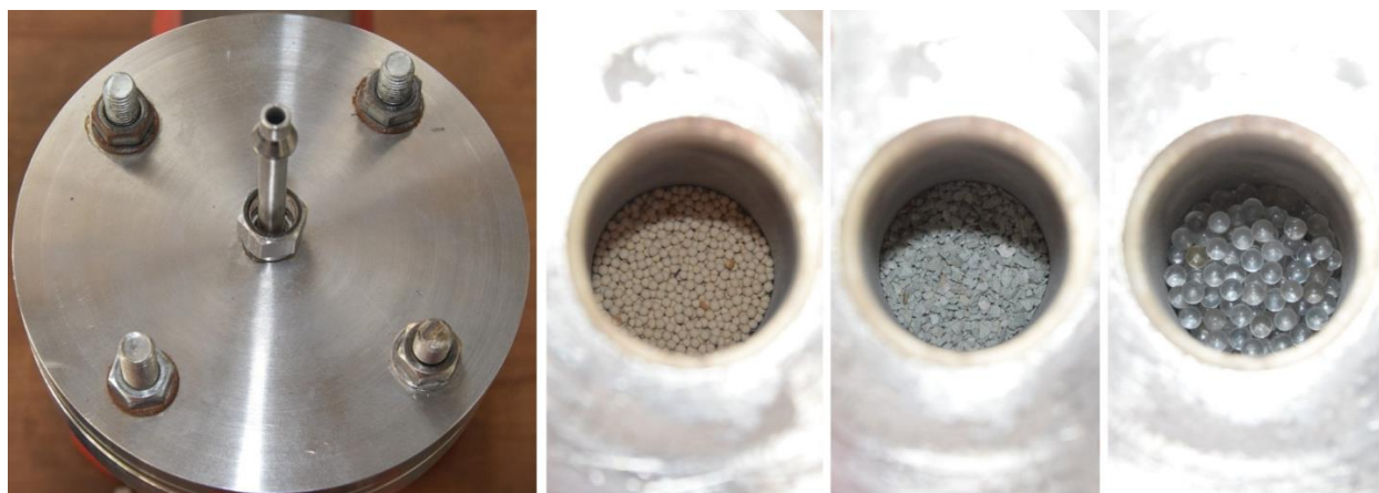
Obr. 2: Vzorky ve vsádkovém adsorbéru (zleva doprava): uzavřená plnicí příruba adsorbéru, molekulové síto 13X, klinoptilolit, inertní náplň pro blank
