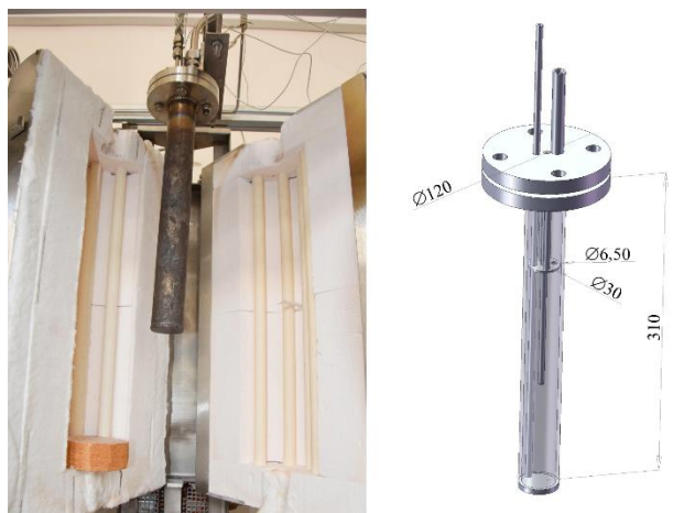
Obr. 5 Detail aktivačního reaktoru (vlevo – umístění v peci, vpravo – průřez)
