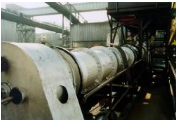
Obr. 5: Foto rotační pece na Koksovně ČSA Fig. 5: Photo of the rotary kiln at the CSA coking Plant
