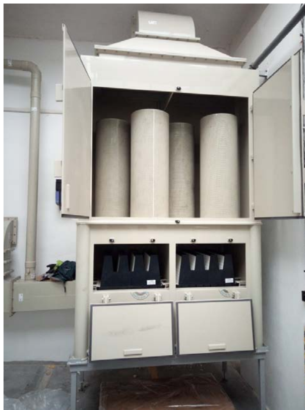
Obr. 4: Adsorpční patrony použité ve druhém stupni čistícího zařízení
