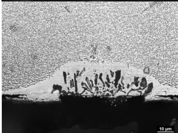
Obr. 8 Snímky korozního napadení do hloubky slitiny Inconel 738 po 1000 hod. expozici v prostředí vysokoteplotního V/HTR helia při 900 °C
