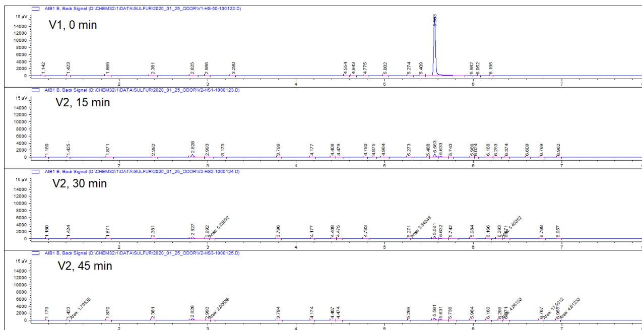
Obr. 1 Porovnání GC-SCD analýz plynů nad vzorky V2 po 15, 30 a 45 min od přidavku roztoku PBS
