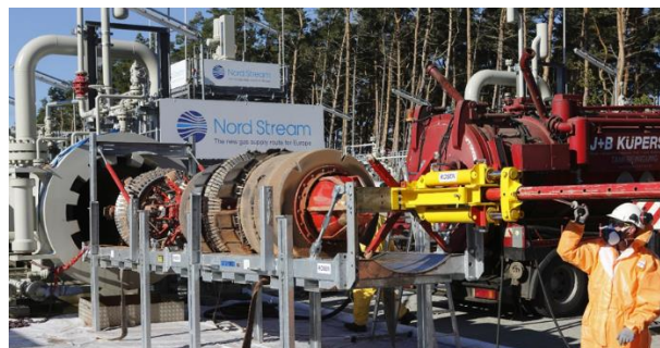
Obr. 5 Inteligentní ježek před ježkovací komorou [7]
