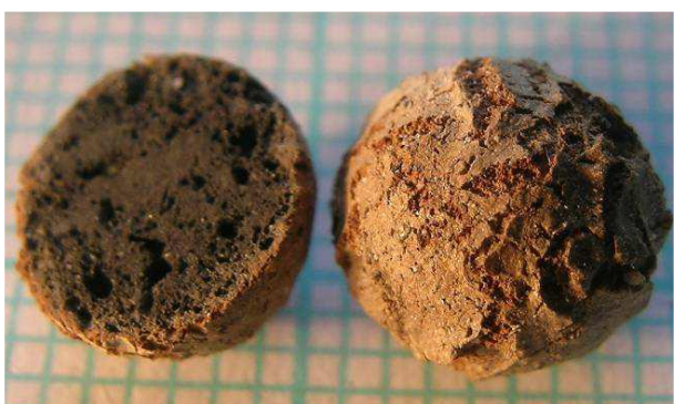
Obr. 5 Řez a povrch zrna z CJ za přídavku 4,5 % hm. DK (podklad - milimetrový papír) Fig. 5. Cut and grain surface of CJ with addition 4.5 wt. % DK (underlay - millimeter scale paper)
