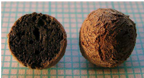
Obr. 4 Řez a povrch zrna z CJ (podklad - milimetrový papír) Fig. 4. Cut and grain surface of CJ (underlay - millimeter scale paper)
