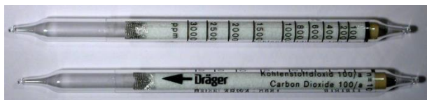
Obr. 1 Detekční trubice pro CO 2 [24]
