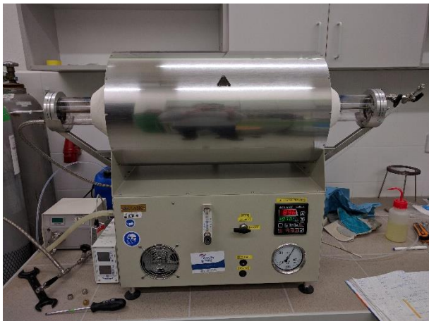
Obr. 4 Fotografie aparatury pro korozní zkoušky materiálů Fig. 4 Photo of apparatus used for corrosion tests of materials
