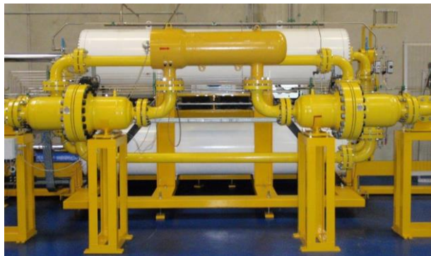
Obr. 10 Zdvojený 4“ pístový etalon průtoku plynu ve FORCE. Zdroj: FORCE Technology Fig. 10 Piston prover at FORCE Technology. Photo credit: FORCE Technology
