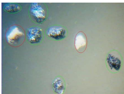
Obr. 8 Zrna uhlí a popelovin velikosti (56 až 80). 10^{-6}\text{m} Fig. 8 Ash and lignite particles (56; 80). 10^{-6}\text{m}
