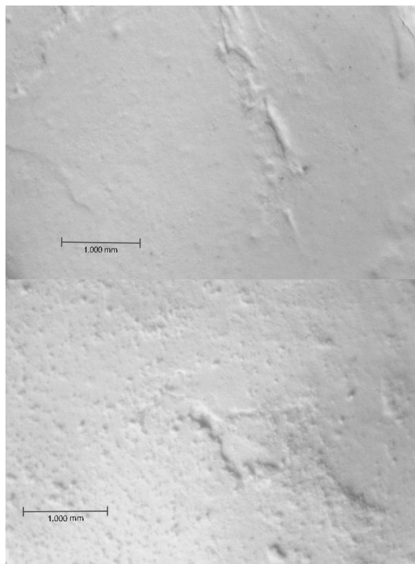
Obr. 9 Detail povrchu před (vlevo) a po (vpravo) dlouhodobé zkoušce vzorku HVIT Fig. 9 HVIT sorbent surface before (left) and after (right) the long term test
