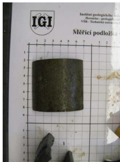
Obr. 3 Vzorek stupačky po reakci s \text{CO}_2
