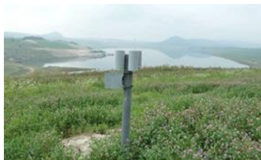
Obr. 3 Stativ s držáky vzorkovnic pro pasivní odběr plynů a prašného spadu
