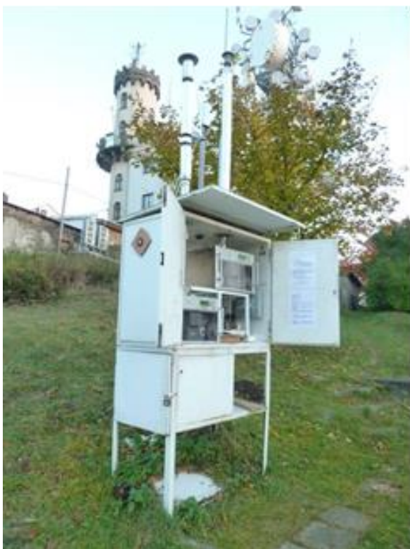
Obr. 4 Stanoviště pro kontinuální měření PM_{10} a TSP na Milešovce
