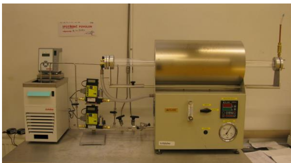
Obr. 12 Vysokoteplotní pec (HTF) se zařízením pro řízené vlhčení plynu pro výzkum odolnosti materiálů v plynné atmosféře za vysoké teploty
