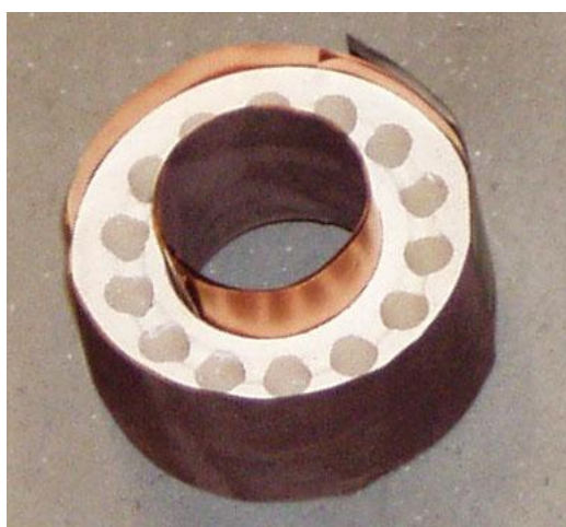
Obr. 4 přiložení měděné fólie na vnitřní a vnější povrch vzorku před měřením povrchového odporu vzorku
